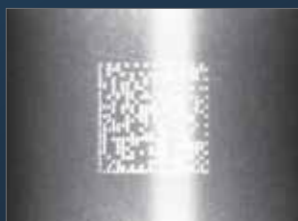
Glare due to reflection
